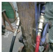
動力源である油圧と電源は掘削機から供給可能なため、パワーパックの用意は不要
